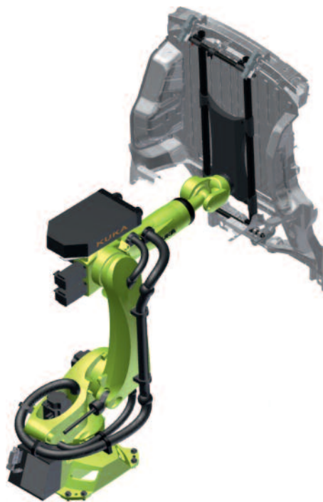
Пример – перемещение днища, весом 115 кг
