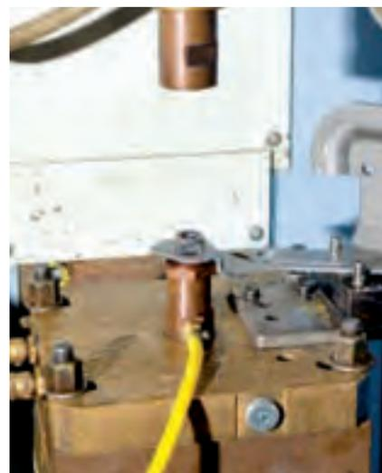
Точное центрирование листа металла и сварной гайки
